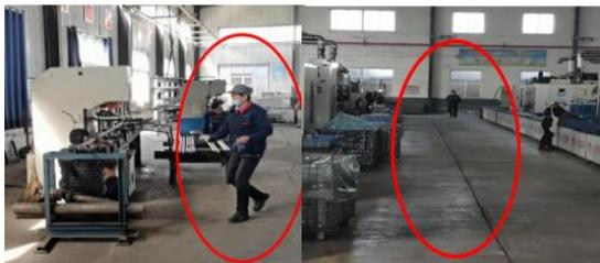
解决建议：重新核定生产车间或班组人员配置；导入、培训生产前准备工作，减少作业时人员随意走动、寻找工具/物料等现象；按节拍少件流或单件流，使生产操作人员有条不紊的同步作业。
