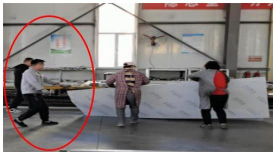
解决建议：1.可调整布局，缩短工序间距离，减少搬运浪费；2.人工搬运利用周转车，设置简单固定装置，1人作业，其余3人正常生产，要求生产不停顿；3.测算作业工时，下达满负荷日
