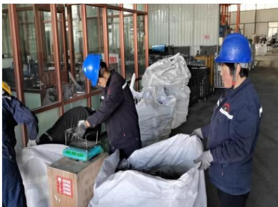
解决建议：1.生产过程中应采取在线检测方式，可增加自动装包装置，质检也可以通过在线抽查、合格后入库，通过在线可以减少装包次数，消除到检测点数次搬运、取放等多种浪费。
