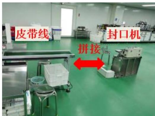
面，左手拿包装袋，右手拿成摞的口罩，装入袋中，右手放入合格证，调整挂绳，左手伸展将未封口的成袋口罩放置在皮带线上，左手回程随手拿起空包装袋，重复以上动作；口罩随着皮带线流动。
