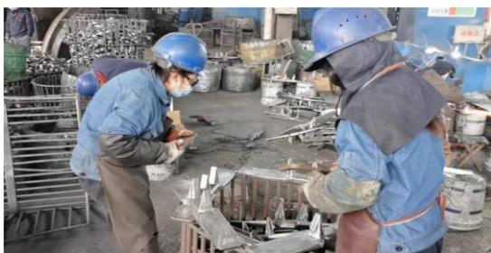
解决建议：1.建立内部物流通道，产品流动可以在线检测，进一步使用三维扫描或自动卡工装报警装置，取消人工质检，减少产品装筐搬运周转浪费、库存浪费、人工成本浪费。
