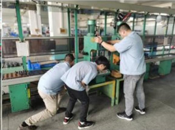
精益老师通过动作模拟、人机配合发现每位员工都是依靠单体设备进行作业，人工组装后启动压床进行压实，然后放置在流水线上进行流动周转。简单测算一下四个工位的作业节拍时间差异不大，提出一大胆建议：舍弃流水线，流转作业不要被流水线给束缚。
